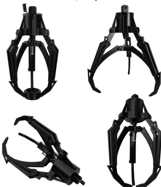
Рисунок 1. Трехпальцевый захват для переноса груза с помощью БПЛА
